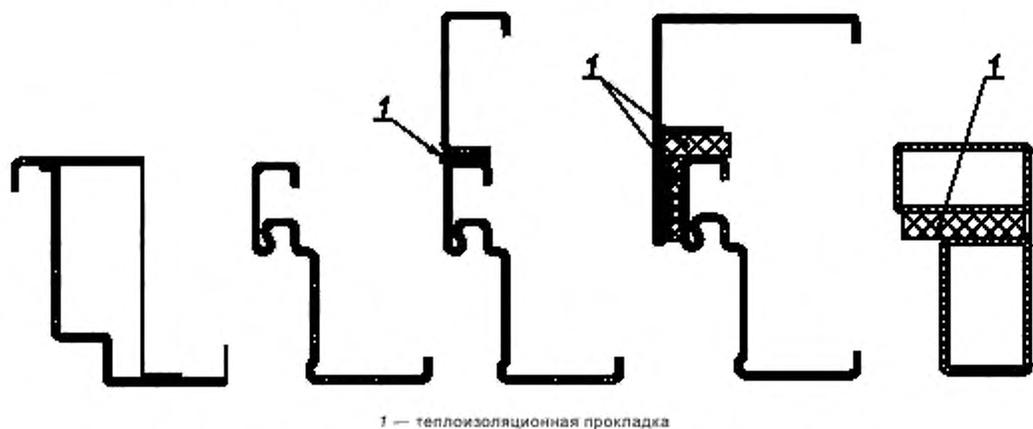
Рисунок Б.1 — Примеры конструктивного исполнения дверных коробок
