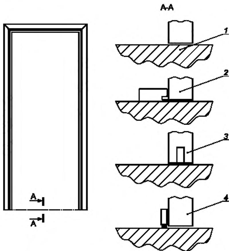
1 — без порога; 2 — с приставным порогом; 3 — с выдвижным порогом встроеного типа;
